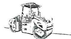
CARPETA DE RODAMIENTO Pasados tres meses de concluir el paso anterior, se procede a colocar la última capa, que consiste en una base de asfalto.
