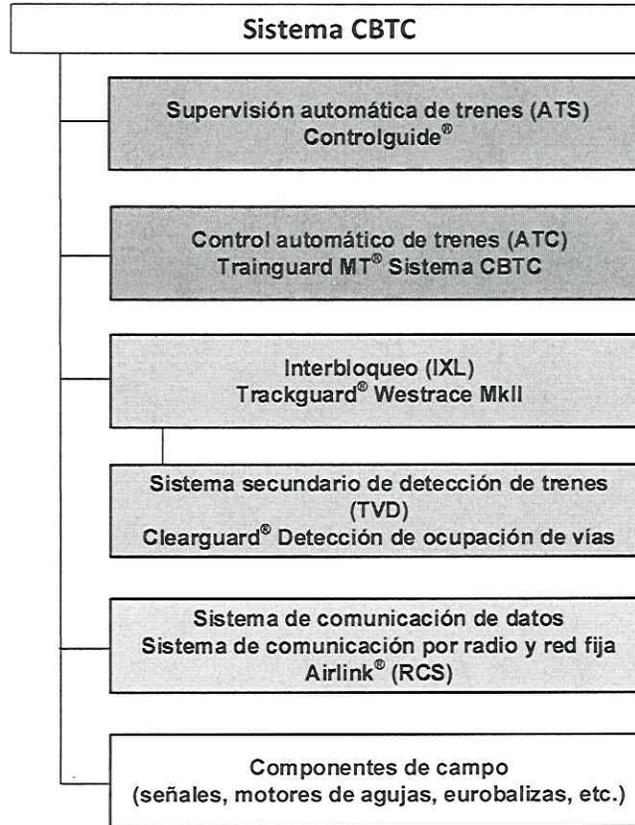
Figura 2 Subsistemas y componentes de CBTC
