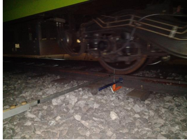
Paso de una de las ruedas del tren por el sensor de desplazamiento
