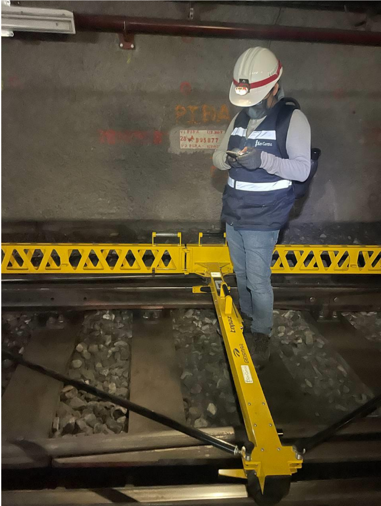
Figura 148. Configurando Equipo Topaz, Inicio de medición en cola de Mixcoac.
