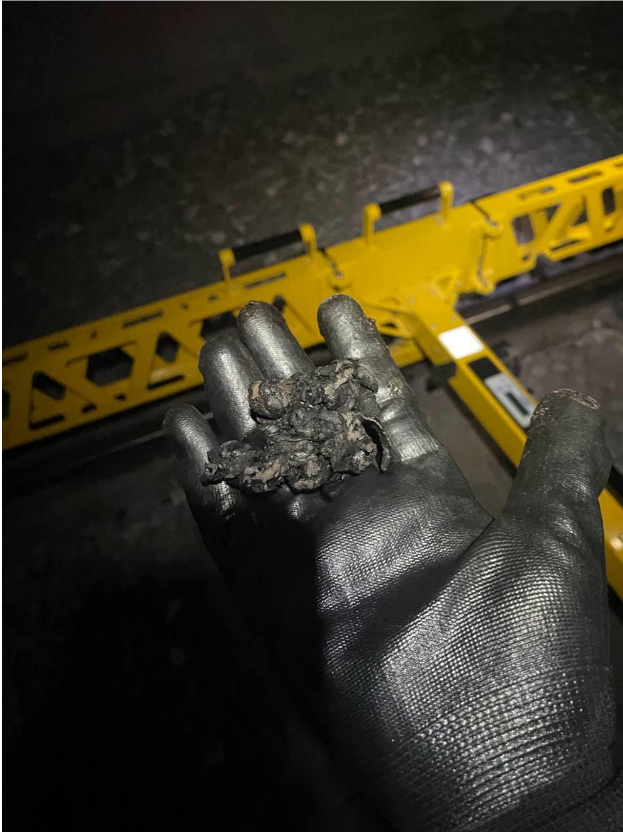
Figura 147. En Cola de Estación Mixcoac, este es el residuo retirado del equipo que se le fue adhiriendo en el trayecto de medición
