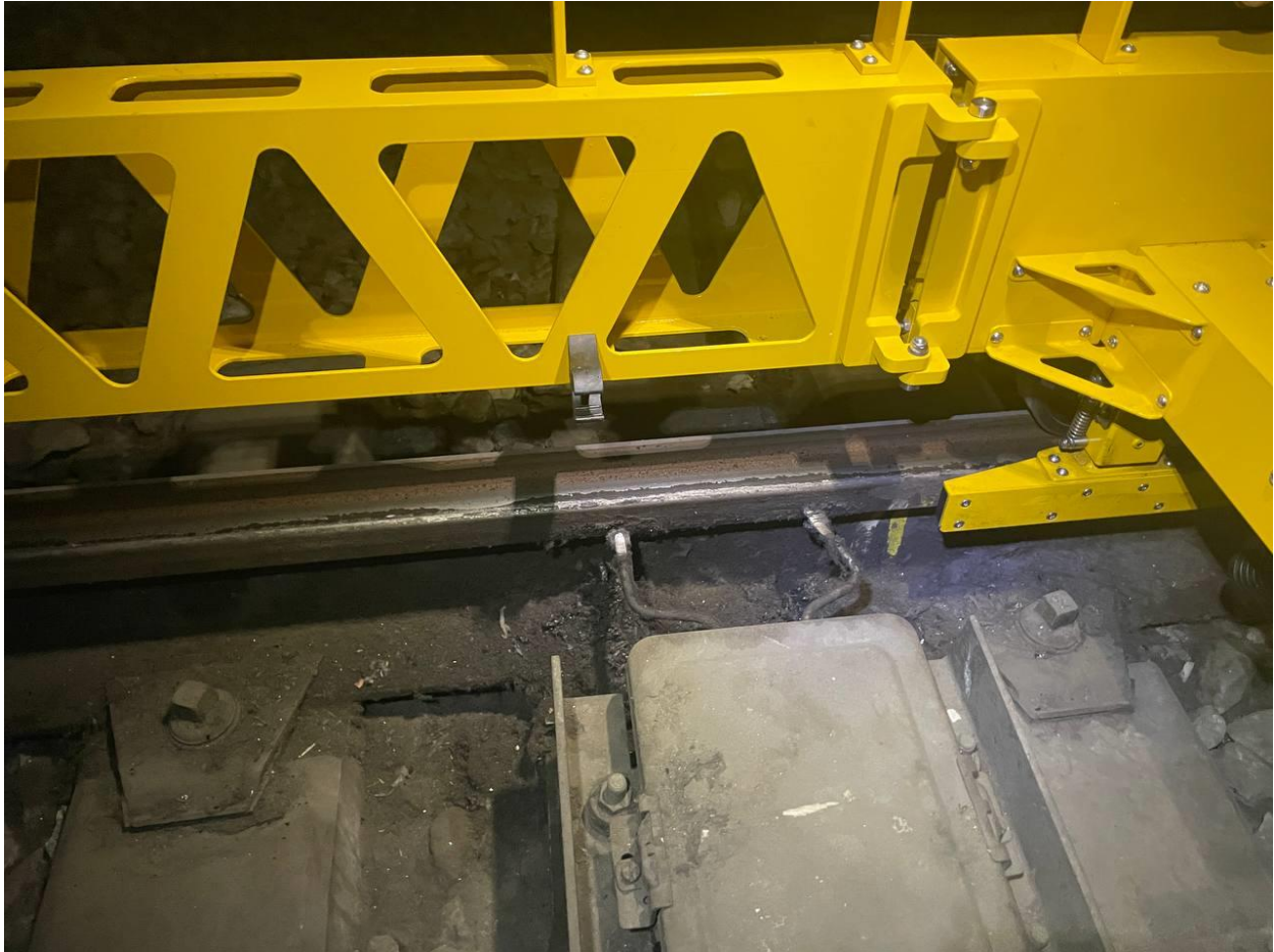
Figura 142. Estación Mixcoac, se encuentran aparatos que impiden el libre tránsito del equipo de medición.
