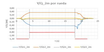
Los valores presentados corresponden al coeficiente de descarrilamiento Y/Q del bogie de ataque (el que peores resultados arroja). La gráfica Y/Q11 (curva azul en la figura) se corresponde con la rueda de ataque, situada en el riel exterior de la curva. Esta es la rueda en la que peores resultados de Y/Q se obtienen. Como puede verse, a medida que aumenta la velocidad, el valor de Y/Q disminuye. En la siguiente tabla se incluyen a modo de resumen los valores de Y/Q en el peor punto.
