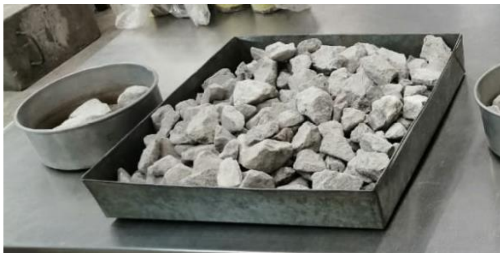
Figura 8 Material retenido en las mallas de 2" y 1 1/2"
