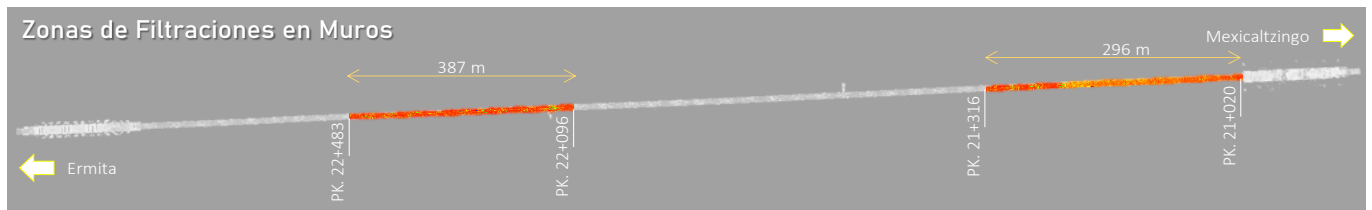
ZONA DE FILTRACIÓN 2 Cad. PK. 22+196 tramo Ermita– Mexicaltzingo
