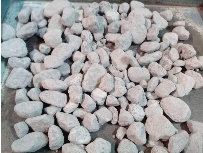
Figura 24 Agregado grueso después del ensaye de desgaste Los Ángeles.
