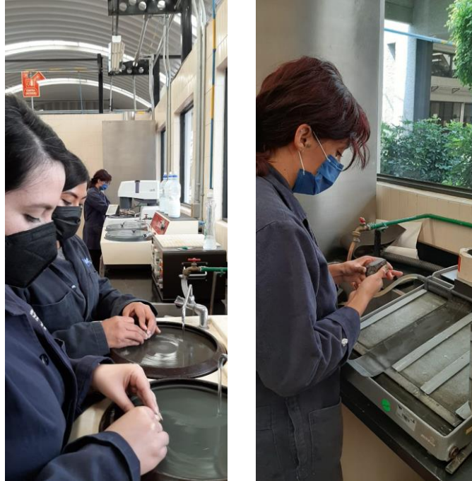
Figura 5. Preparación petrográfica de las muestras.
