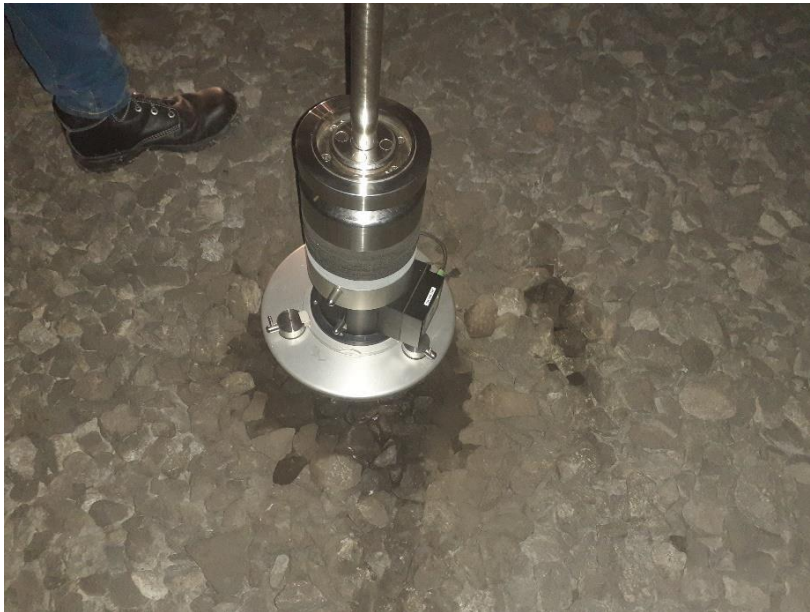
Figura 10 LWD en pruebas sobre punto de interés, cadenamiento 27+340.
