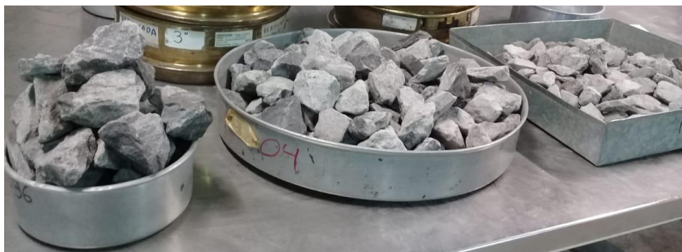
Figura 22 Material antes del ensaye de desgaste Los Ángeles
