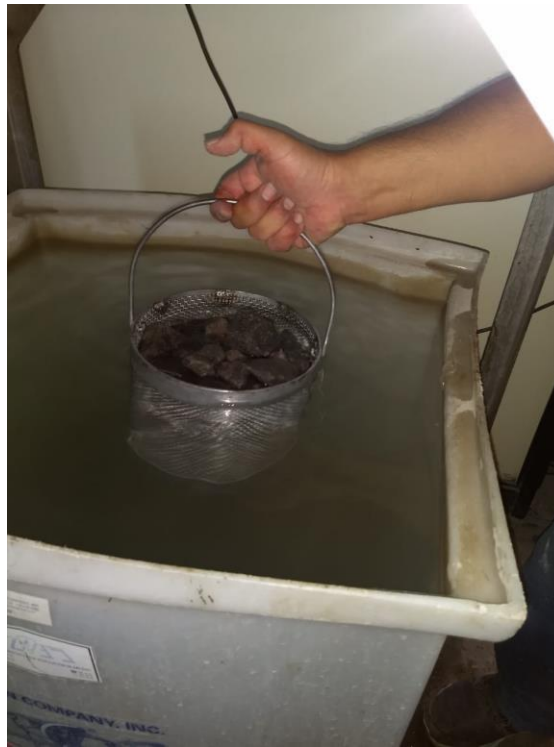
Figura 26 Determinación de densidad y absorción de las muestras de balasto.
