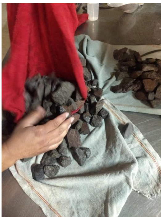
Figura 25 Preparación de muestras para densidad y absorción de las muestras de balasto.
