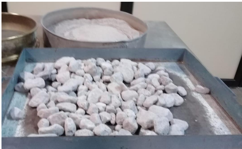
Figura 23 Material después del ensaye de desgaste Los Ángeles.
