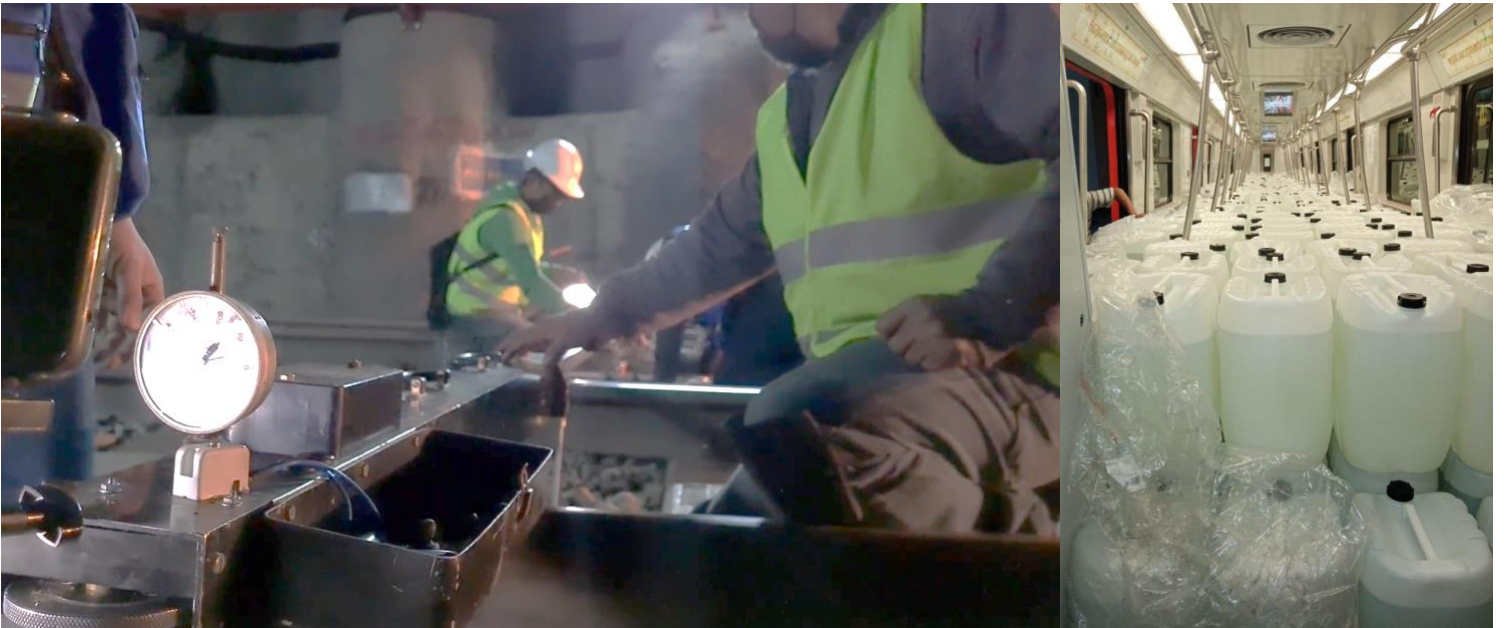
Prueba de módulo de vía, PCI, 2021
