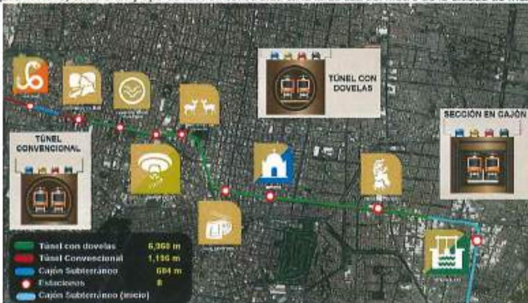
Figura 2. Trazo, estaciones y tipo de sección construida correspondiente al tramo en túnel.
