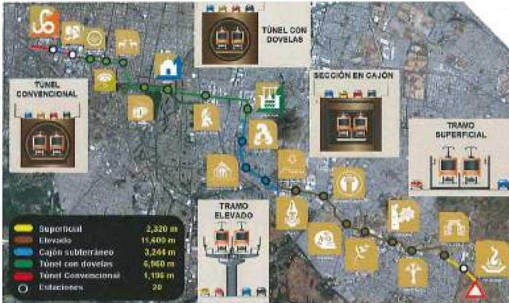
Figura 1. Trazo, estaciones y tipo de sección construida en la línea L12 del metro de la Ciudad de México.
