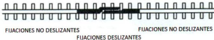
Figura 6: Aparato de dilatación: zona a auscultar mediante ultrasonidos
