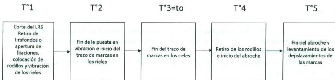
T°1: temperatura al corte del riel (inicio de la anulación de esfuerzos)
