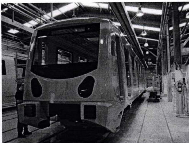
**Fotografía 39.** Carro con núm. de golpe FR2-052 en el área de inspección final de pintura.
