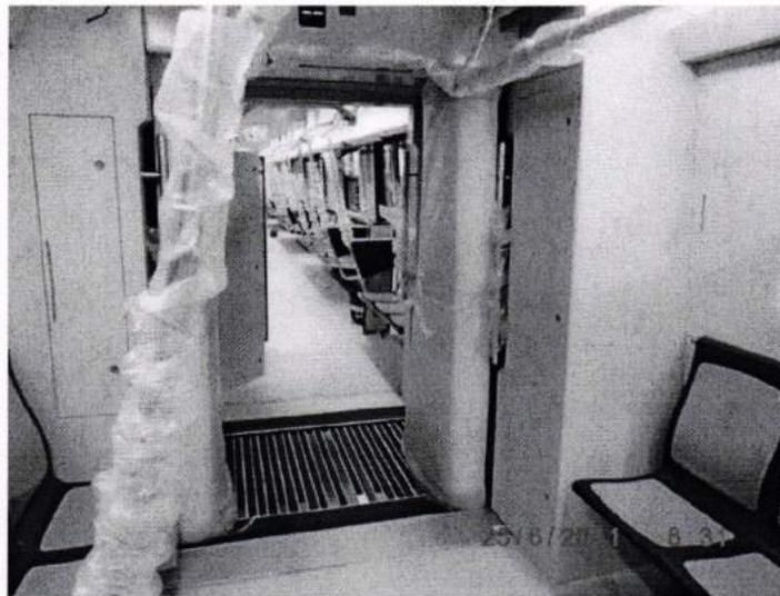
**Fotografía 61.** Instalación de acople entre vagones
