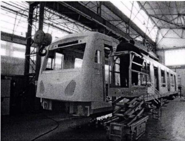
**Fotografía 33.** Montaje de testero de poliéster en carro.
