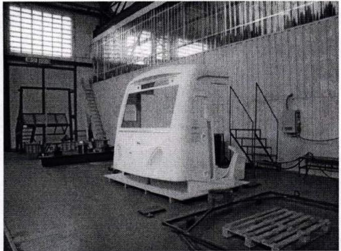
**Fotografía 32.** Testero de poliéster a montar en carro.
