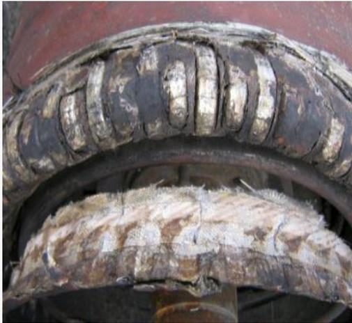
INDUCIDO DE MOTOR DE TRACCIÓN (ROTOR) CON
