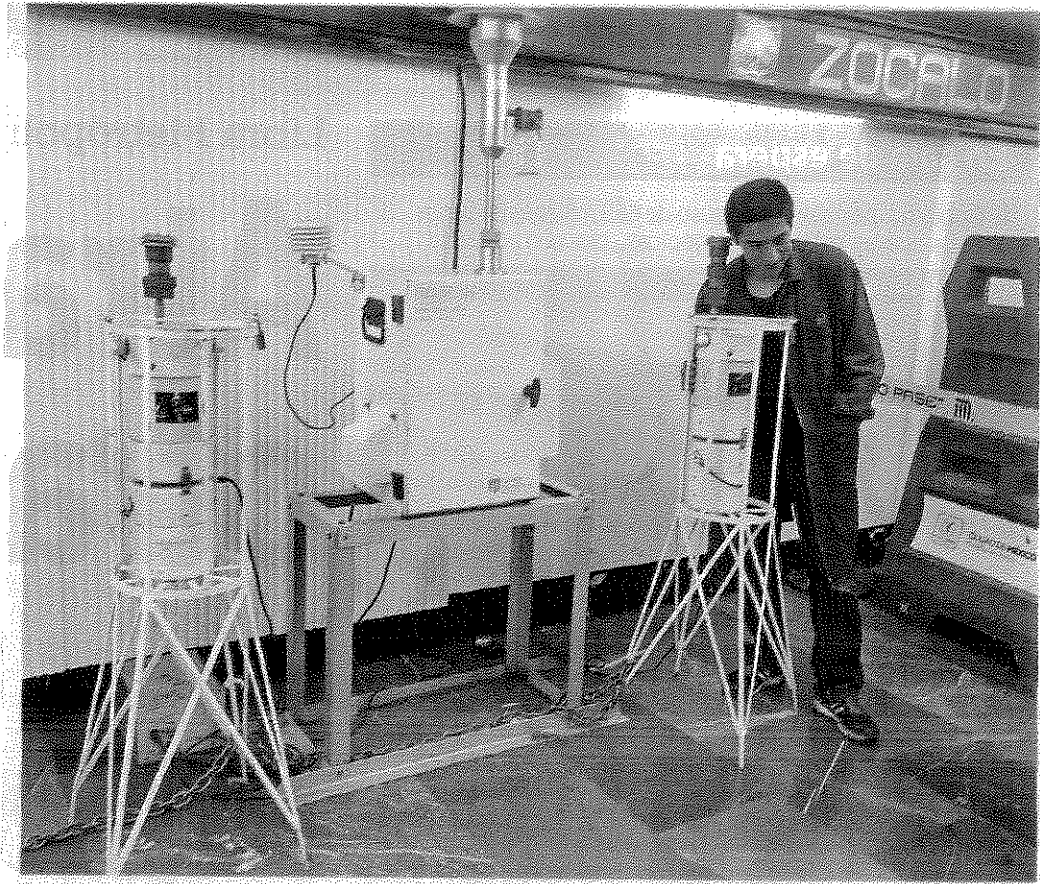
■ En la estación Zócalo, unas bombas muestrean el polvo que está suspendido.
